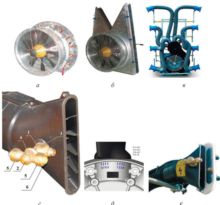
Рис. 4.13. Вентиляторные приставки к садовым опрыскивателям: а – стандартная; б – «колонна»; в – «спрут»; г – воздушный диффузор с установленной распыливающей головкой; д – регулировка угла атаки лопастей вентилятора; е – воздушный диффузор с электростатической зарядкой капель; 1 – корпус; 2 – винт; 3 – отсечной клапан; 4 – поворотный корпус; 5 – накидные гайки; 6 – распылитель
