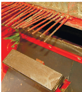
Рис. 6.27. Датчик ДПЗП-1 за решетками очистки
