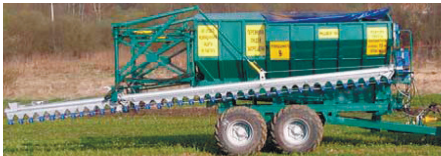
Рис. 2.13. Кузовной штанговый механический рассеиватель твердых минеральных удобрений
