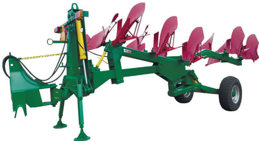
Рис. 1.13. Многокорпусный плуг с модульным принципом устройства
