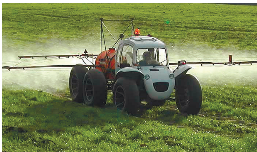
Рис. 2.18. Работа комплекса «РОСА» при внесении жидких минеральных удобрений и средств защиты растений
