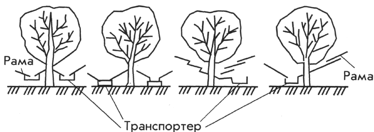
Рис. 10.12. Установка уловителей и транспортеров под штамбами деревьев
