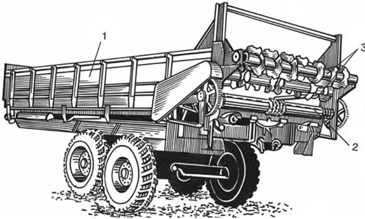
Рис. 2.1. Разбрасыватель органических удобрений: 1 – кузов; 2 – транспортер; 3 – распределяющее устройство
