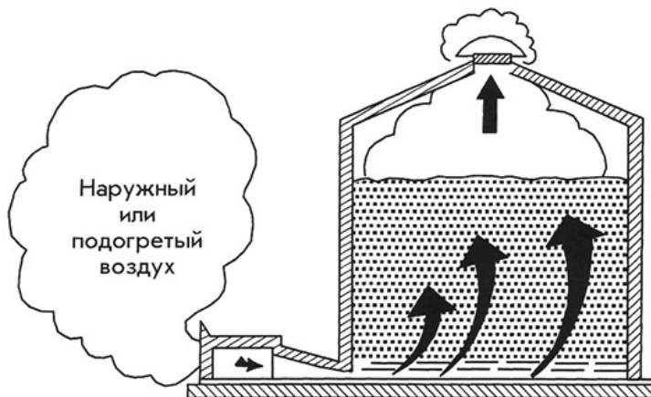
Рис. 7.13. Технологическая схема активного вентилирования зерна
