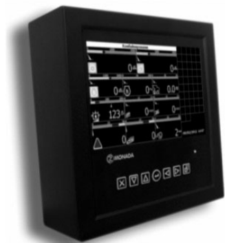
Рис. 6.26. Блоки контроля и индикации технологического режима работы комбайнов: а – БКИ-03; б – ВулКан-04
