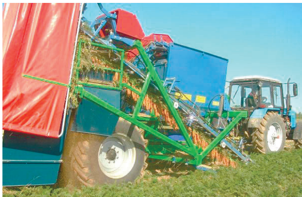
Рис. 10.3. Однорядный комбайн для уборки моркови
