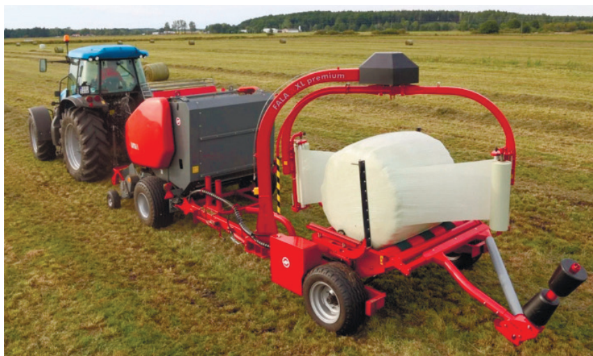
Рис. 5.13. Пресс-подборщик с устройством для упаковки рулонов в пленку
