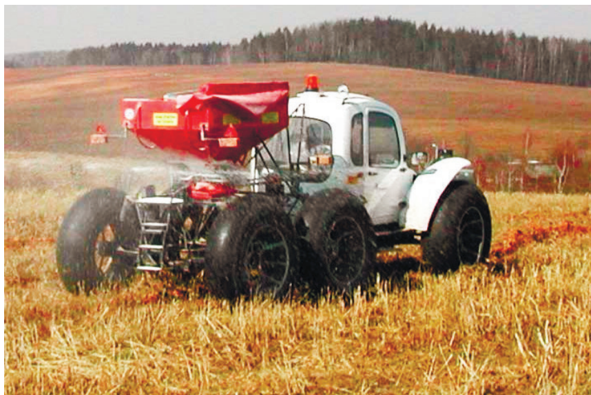
Рис. 2.17. Энергосредство «РОСА» при внесении твердых минеральных удобрений
