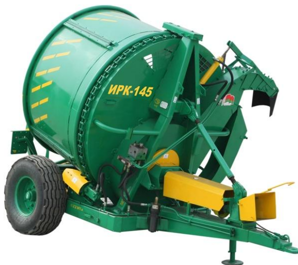
Рис. 17. Общий вид измельчителя рулонов грубых кормов ИРК-145
