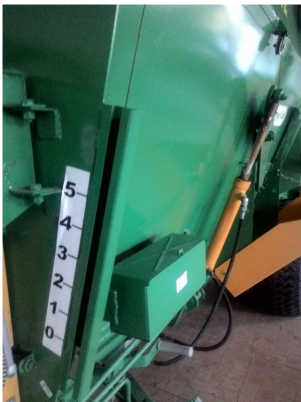
Рис. 10. Регулировочные положение шиберной заслонки
