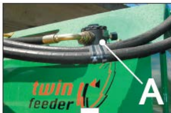
Рис. 31. Очистка фильтра гидросистемы
