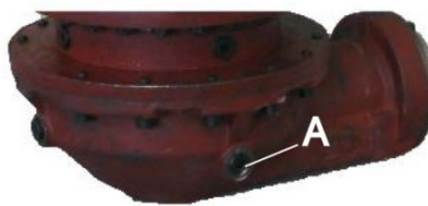
Рис. 32. Замена масла в редукторе
