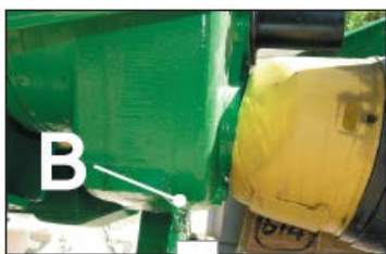
Рис. 32. Замена масла в редукторе
