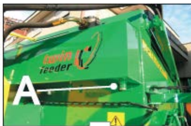
Рис. 33. Замена масла в баке
