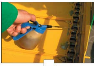
Рис. 26. Смазка цепей скребкового транспортера
