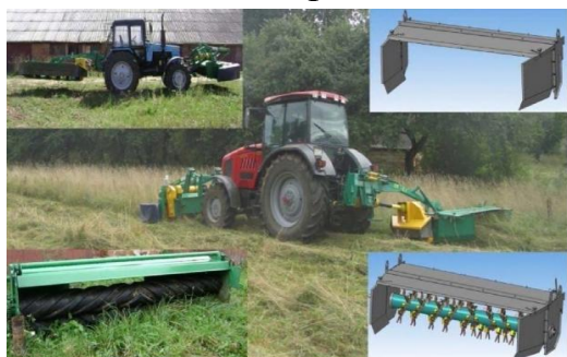
Рис. 2. Косилки применяемые для скашивания трав: 1 – КПП-3,1; 2 - КДП-3,1; 3- КБМ-6; 4 – КПП-9.
