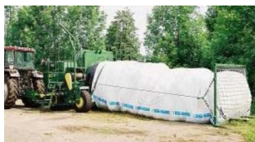
Рис. 10.7. Упаковщик сенажной и силосной массы в полимерный рукав УСМ-1
