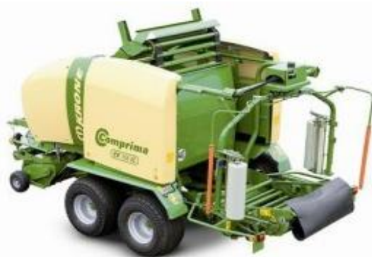
Рис. 10.6. Пресс-подборщик «Comprima CF 155»
