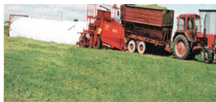
Рис. 10.7. Упаковщик сенажной и силосной массы в полимерный рукав УСМ-1
