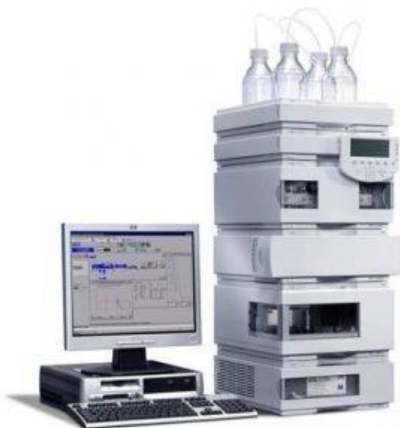
Рис. 5. Жидкостной хроматограф высокого давления Agilent 1100
