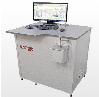
Рис. 3. Многоканальный анализатор атомно-эмиссионных спектров МАЭС
