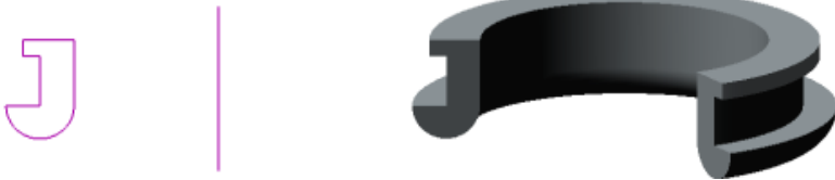
Рис. 4. Эскиз и элемент, образованный операцией вращения
