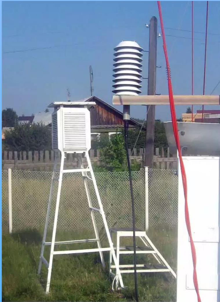
Психрометрическая будка (на заднем плане) и датчик измерения температуры и влажности воздуха финской фирмы "Vaisala" (на переднем плане) Метеостанция Миасс
