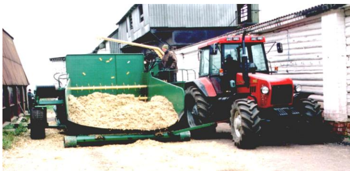
Рис. 14.3. Упаковщик сенажно-силосной массы УСМ-1
