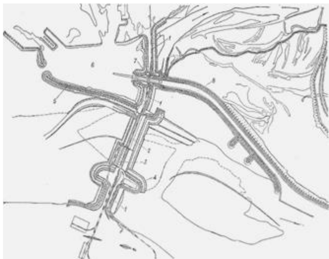
Рис. 1.38. Пример пойменной компоновки ГЭС: 1 – земляная плотина; 2 – водосливная плотина; 3 – здание ГЭС; 4 – повышающая подстанция; 5 – оградящая дамба; 6 – аванпорт; 7 – судоходный шлюз; 8 – судоходный канал
