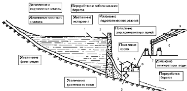
Рис. 3.4. Виды воздействия ГЭС на окружающую среду: 1 – водохранилище; 2 – плотина; 3 – здание ГЭС; 4 – генератор; 5 – турбина; 6 – повышающий трансформатор; 7 – подстанция; 8 – линия электропередачи; 9 – потребители электроэнергии
