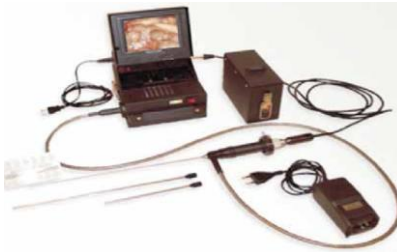
Рис.8 Эндоскопическая система для определения пола и стадий зрелости.
