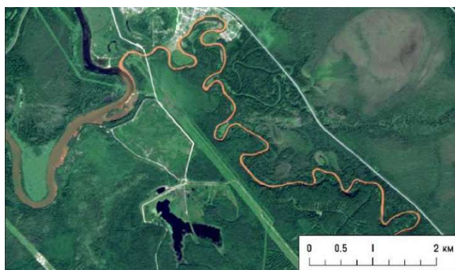
Р и с . 5.34. Загрязнение реки кислыми водами с высокой концентрацией железа, изливающимися из затопленных шахт Кизеловского угольного бассейна. Снимок Sentinel—2 в синтезе естественных цветов
