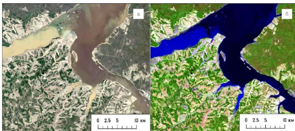
Рис. 5.33. Поступление воды с повышенной мутностью в Камское водохранилище в период весеннего половодья. Снимок Landsat—8 в синтезе естественных цветов (а), и в синтезе SWIR-NIR-RED (б)
