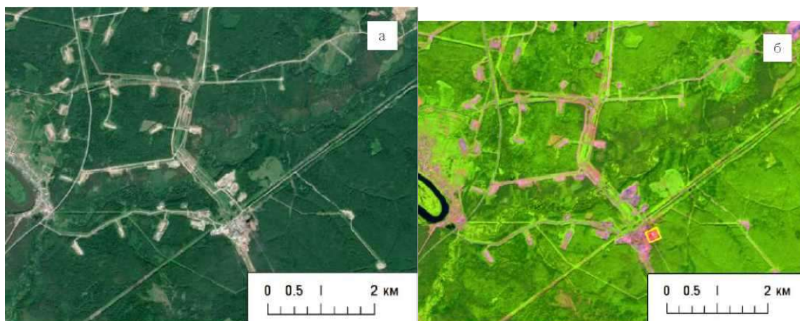
Рис. 5.26. Разрабатываемое нефтяное месторождение на снимке Sentinel-2 летнего сезона в синтезе естественных цветов (а), и в синтезе SWIR-NIR-RED (б), прямоугольником выделен факел сжигания попутного газа
