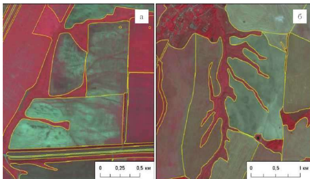
Рис. 5.13. Участки эрозии на снимке SPOT—6 в синтезе каналов NIR—RED—GREEN: а) распаханнные; б) выведенные из сельскохозяйственного оборота. Желтыми контурами обозначены границы полей
