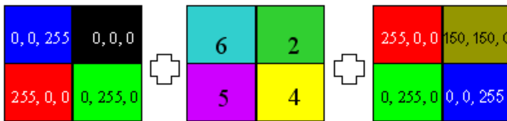
Рис. 9. Схема отображения мозаики растров при применении режима «Отклонить»
