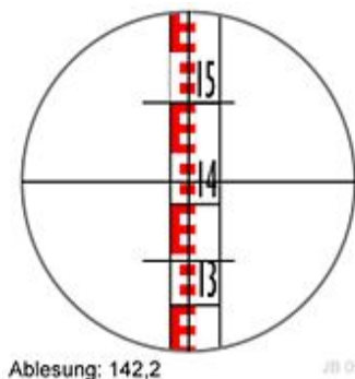
Fernrohrblick auf Nivellierlatte
