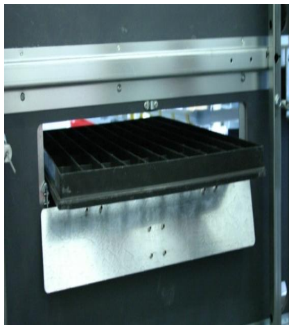
Рис. 2.22. Система транспортировки инкубационных лотков
