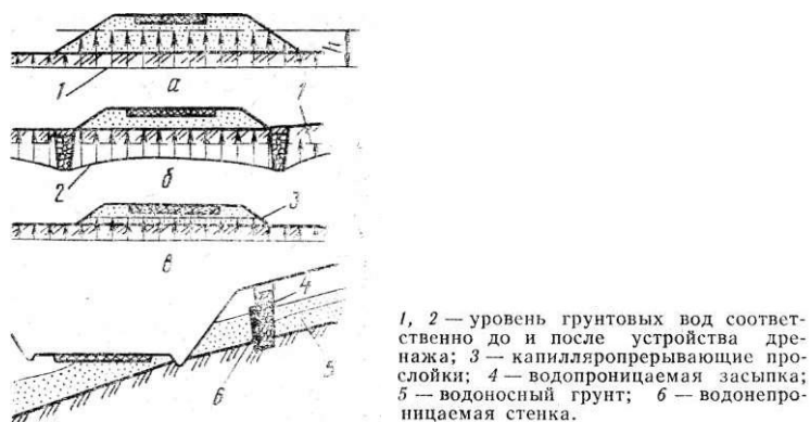
Рисунок 4. Способы защиты дороги от воздействия грунтовых вод
