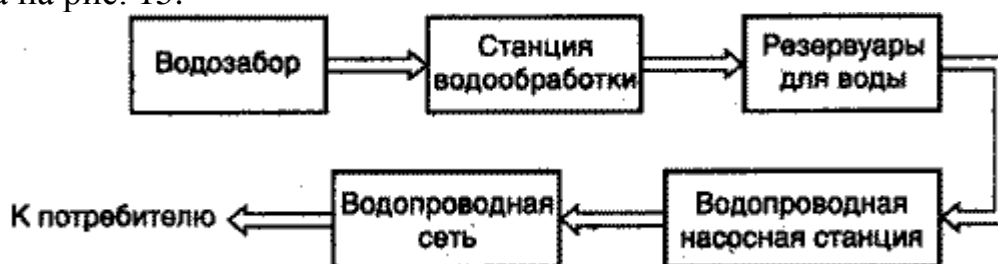
Рисунок 15. Принципиальная схема централизованной системы водоснабжения
