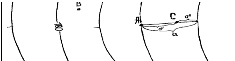
Рис. 4.3. Определение высоты точки, лежащей на горизонтали и между горизонталями
