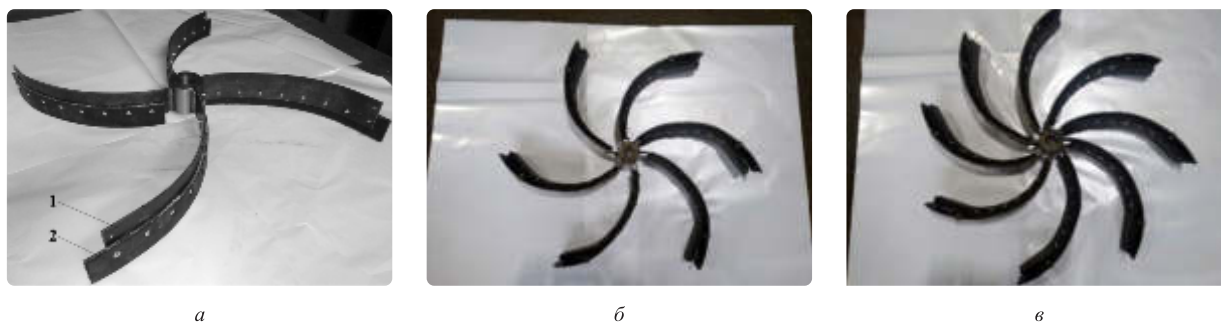
Рис. 4. Рабочие органы машины для очистки семян: 1 – лопатка; 2 – накладка из износостойкой резины класса А; а – с 4 лопастями; б – с 6 лопастями; в – с 8 лопастями
