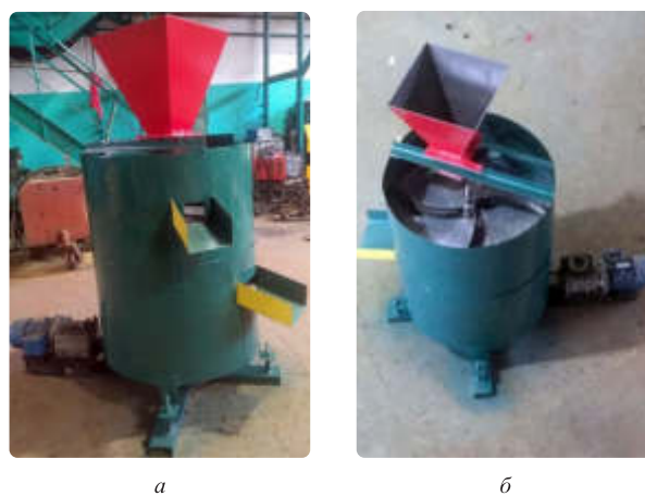
Рис. 3. Опытный образец машины для очистки семян карусельного типа: а – вид сбоку; б – вид сверху
