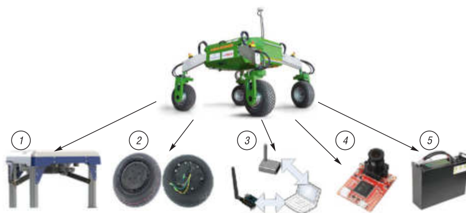
Рис. 3. Структурная схема роботизированной платформы: 1) – рама; 2) – управляемые мотор-колеса; 3) – система навигации и управления; 4) – система технического зрения; 5) – система питания
