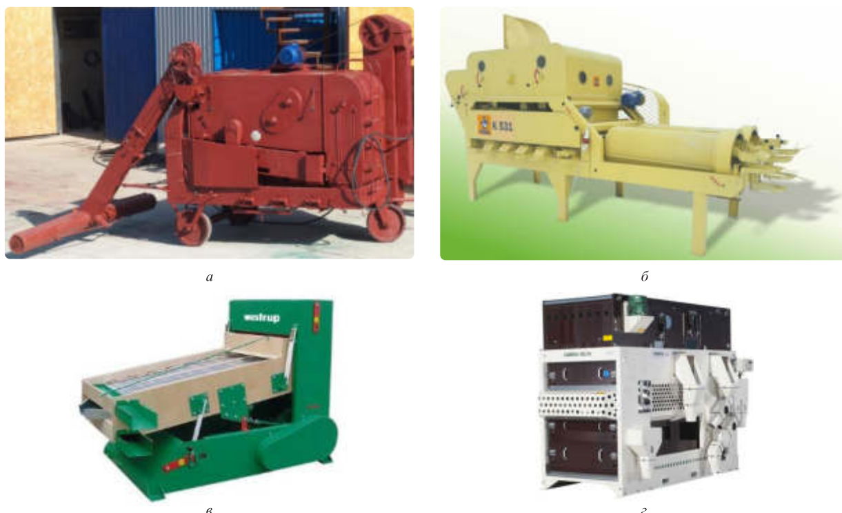
Рис. 1. Машины для очистки семян: а – ОС-4,5А; б – PETKUS «Гигант» К-531; в – WESTRUP PC; г – CIMBRIA DELTA
