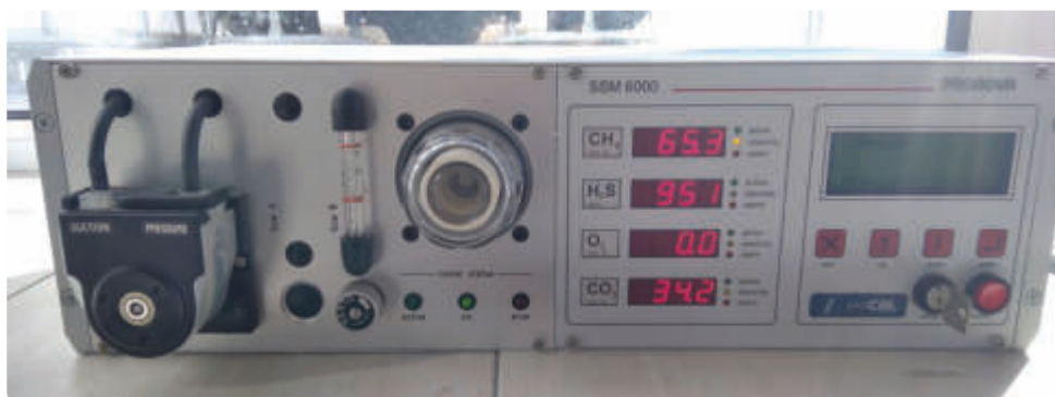
Рис. 3. Результаты измерения состава биогаза по четырем компонентам: CH 4 ; CO 2 ; H 2 S; O 2
