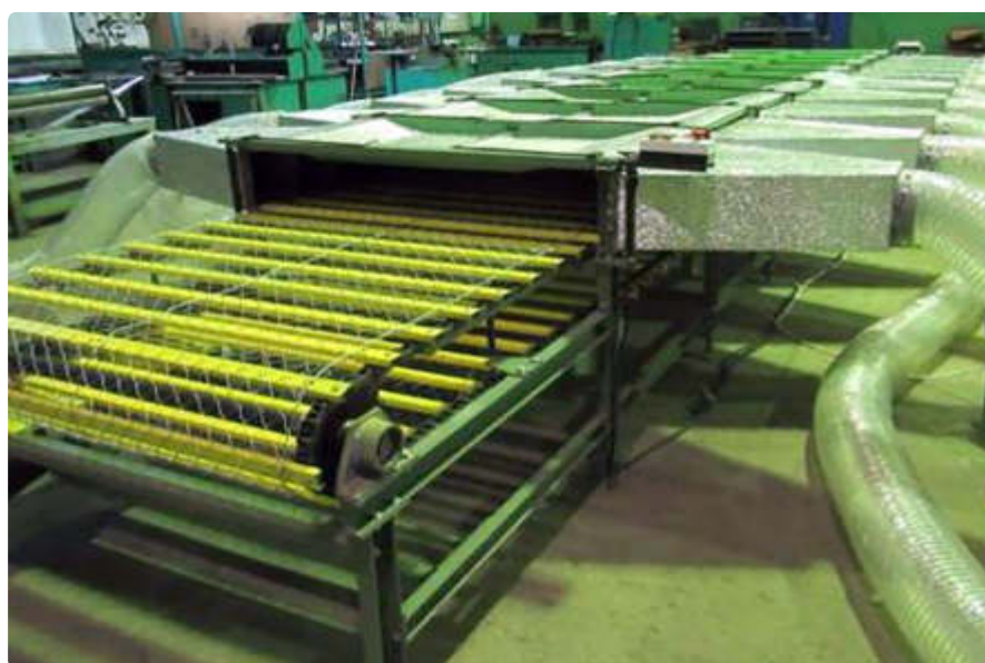
Рис. 2. Схема и вид машины сушильной МС-1 для льнотресты льна-долгунца: а – вид сверху; б – вид со стороны входа льнотресты: 1 – рама; 2 – транспортер (конвейер); 3 – узлы вентиляторные правые; 4 – узлы вентиляторные левые; 5 – воздухораспределители правые; 6 – воздухораспределители левые; 7 – воздухосборники правые; 8 – воздухосборники левые; 9 – узел вентилятора отработанного воздуха; 10 – осадочная камера; 11 – камера смешивания; 12 – ограждение сушильной камеры; 13 – привод транспортера
