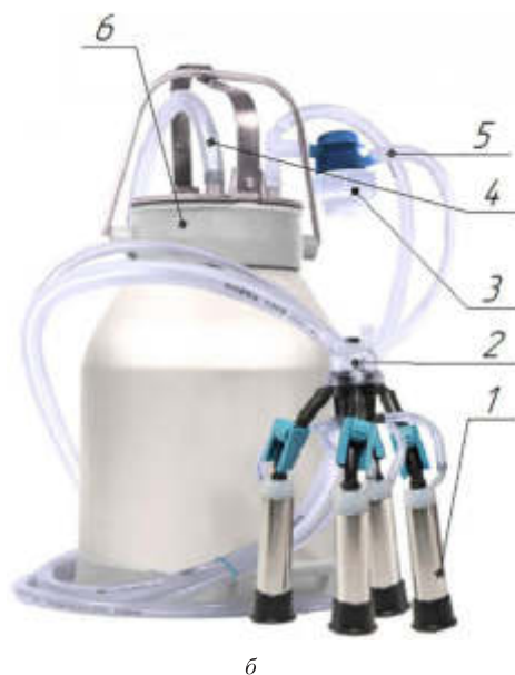
Рис. 3 Общее устройство доильных аппаратов со сбором молока а) в молокопроводе; б) доильное ведро: 1 – доильный стакан; 2 – коллектор; 3 – пульсатор; 4 – молочный шланг; 5 – вакуумный шланг; 6 – доильное ведро
