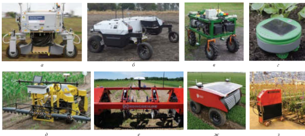
Рис. 1. Роботы для борьбы с сорняками и целенаправленного опрыскивания: а) BoniRob(Deepfield Robotics); б) AgBot II(Queensland University of Technology); в) Autonomie Roboter (Osnabrück University); г) Tertill (Franklin Robotics); д) Hortibo; е) Kongskilde Robotti; ж) RIPPA (The University of Sydney); з) Spray robot (Hollandgreenmachine)
