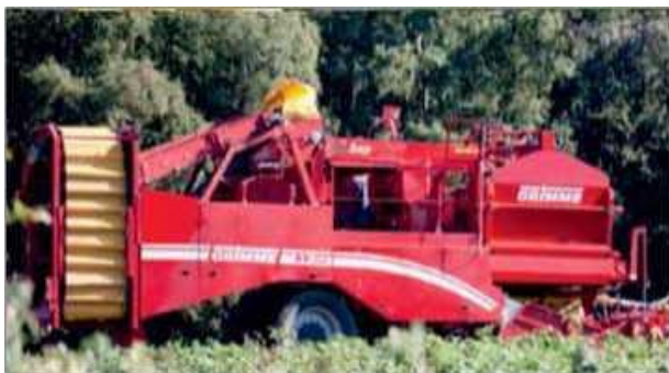
Рисунок 7.4 – Пневматический сепаратор примесей Airsep
