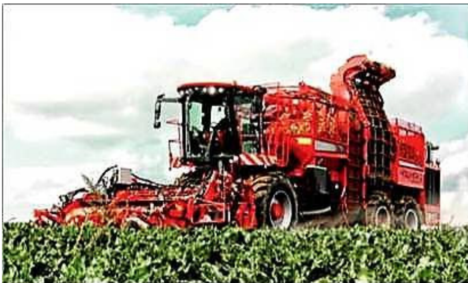
Рисунок 7.1 – Самоходный свеклоборочный комбайн Terra DOS фирмы Holmer
