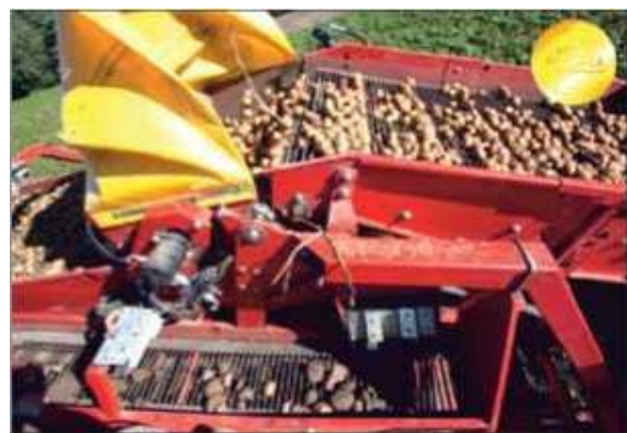
Рисунок 7.4 – Пневматический сепаратор примесей Airsep
