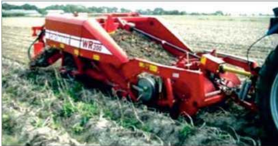
Рисунок 7.3 – Двухрядный копатель-валкоукладчик WR-200
