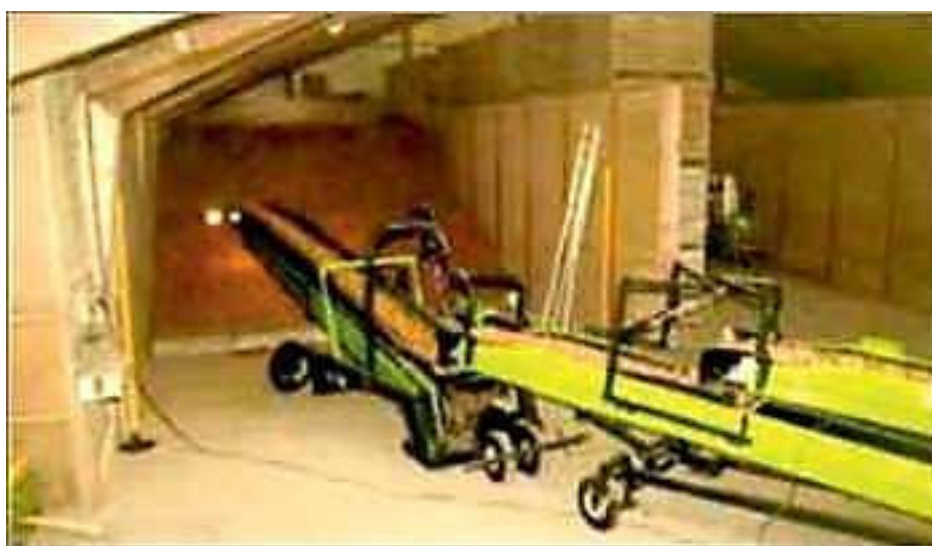
Рисунок 7.5 – Загрузочный элеватор Miedema LBV фирмы Miedema (Нидерланды)
