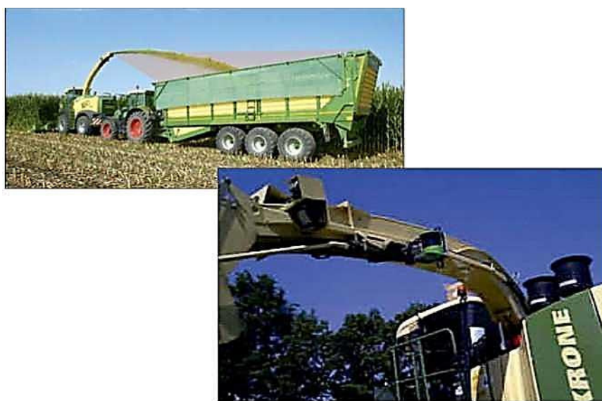
Рисунок 5.2 – Автоматический предохранитель от перегрузок Laser Load для самоходных кормоуборочных комбайнов серии BIG X
