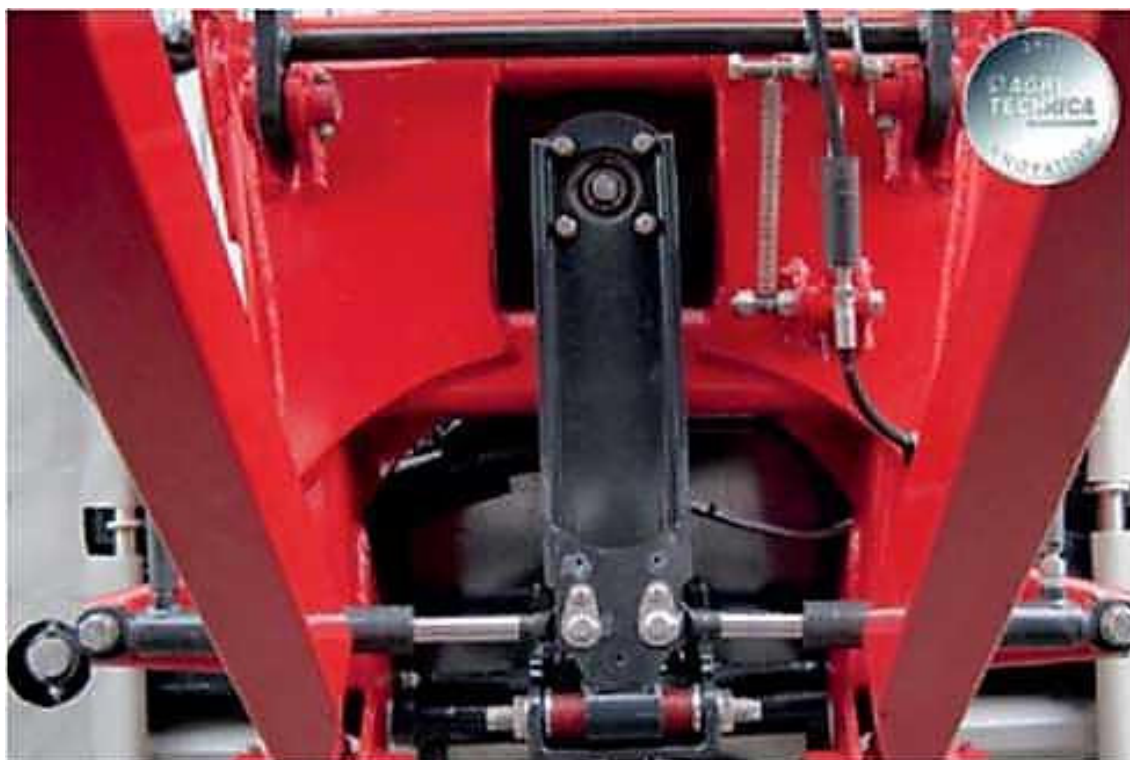
Рисунок 4.7 – Система управления положением штанг Boom Guidance
