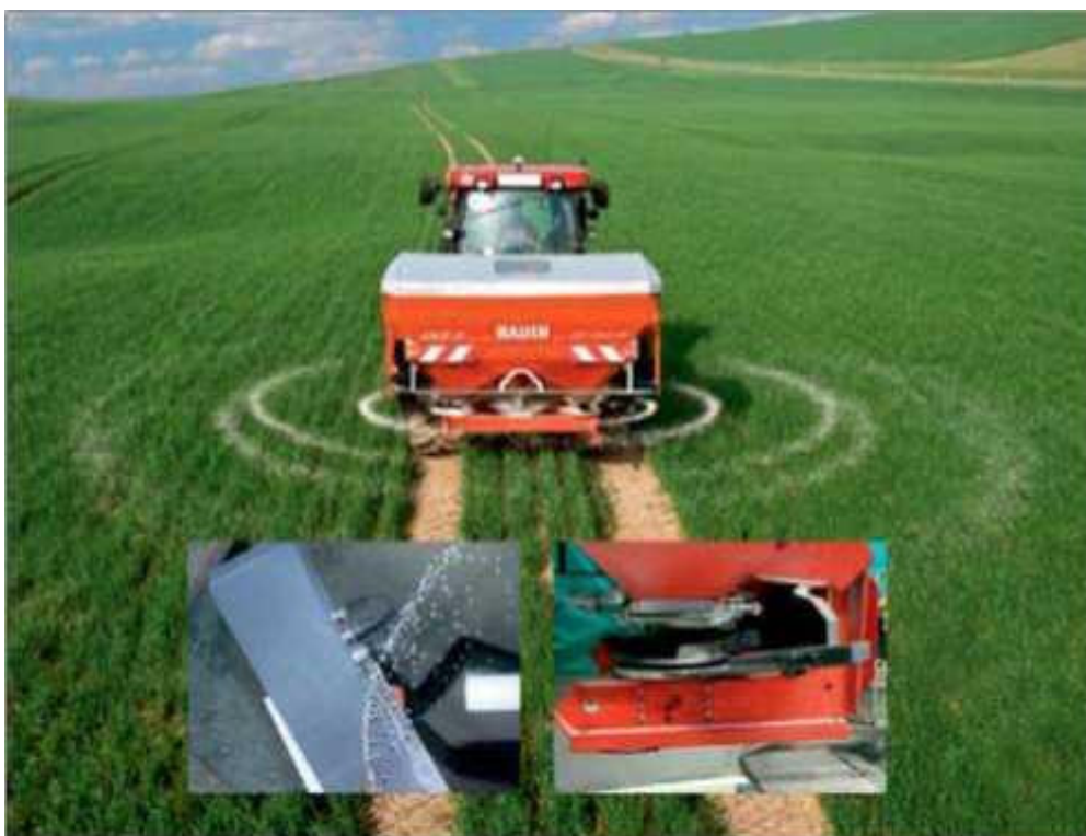
Рисунок 4.1 – Разбрасыватель удобрений Rauch АХМАТ
