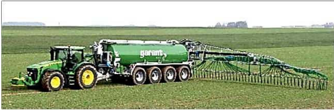
Рисунок 4.5 – Машина для внесения жидких органических удобрений фирмы Kotte-Landtechnik (Германия)
