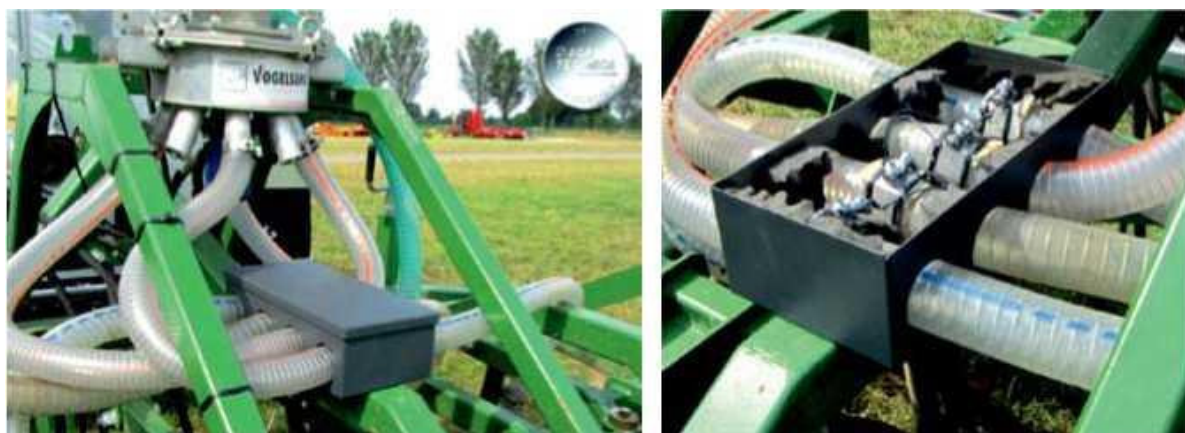
Рисунок 4.6 – Система контроля проходимости шлангов распределителя жидких органических удобрений FlowCheck
