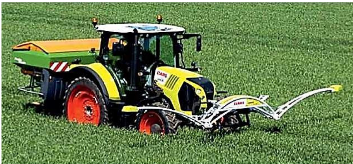
Рисунок 4.10 – Сенсорный датчик CROP SENSOR ISARIA
