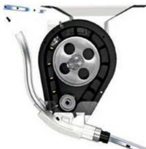
Рисунок 3.3 – Высевающий аппарат сеялки точного высева мод. PCS
