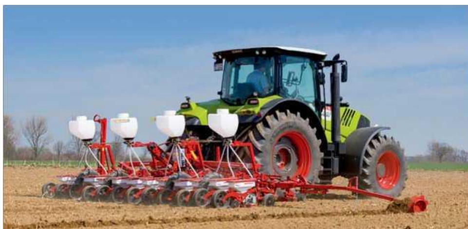
Рисунок 3.6 – Сеялка Kverneland Monopill с приложением GEOseed®
