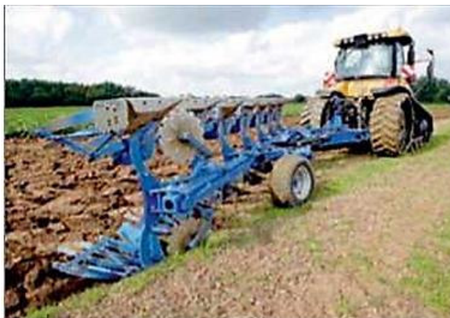
Рисунок 2.1 – Семикорпусный оборотный плуг фирмы Rabe Agri GmbH
