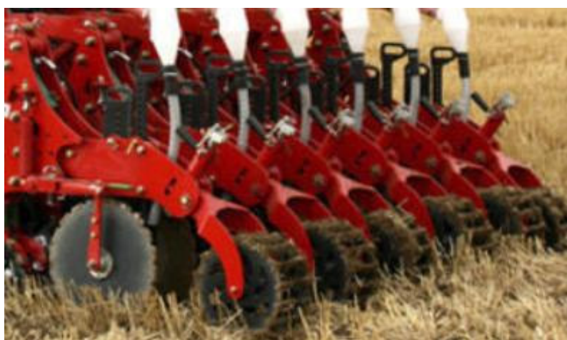
Рисунок 2.9 – Передние режущие диски диаметром 450 мм регулируются из кабины
