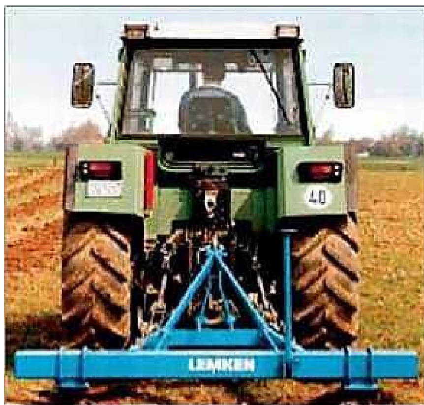
Рисунок 2.3 – Глубокорыхлители Labrador фирмы Lemken Германия
