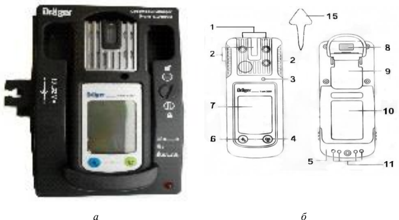
Рис. 22. Комплексный газоанализатор фирмы «Дрегер» для определения углекислого газа, аммиака и сероводорода: а – внешний вид; б – устройство газоанализатора: 1 – поступление газа; 2 – сигнальный светодиод; 3 – звуковое сигнальное устройство; 4 – кнопка ОК; 5 – блок питания; 6 – Кнопка +; 7 – дисплей; 8 – ИК-интерфейс; 9 – зажим для крепления; 10 – паспортная табличка; 11 – зарядные контакты; 12 – индикация измеряемого газа; 13 – индикация измеренного значения; 14 – специальные символы; 15 – инструмент для замены сенсора
