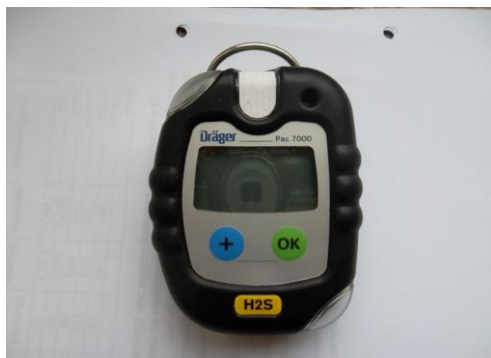
Рис. 21. Газоанализатор фирмы «Дрегер» для определения сероводорода: а – внешний вид; б – устройство газоанализатора: 1 – сигнальный светодиод; 2 – звуковое сигнальное устройство; 3 – дисплей (концентрация газа); 4 – кнопка ОК для включения/выключения прибора и квитирования тревог; 5 – кнопка + для выключения прибора и проведения функциональной проверки; 6 – впускное отверстие; 7 – винт; 8 – пружинный зажим; 9 – паспортная табличка; 10 – ИК-интерфейс
