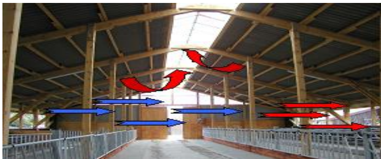
Рис. 45. Схема движения воздушных масс в коровнике
