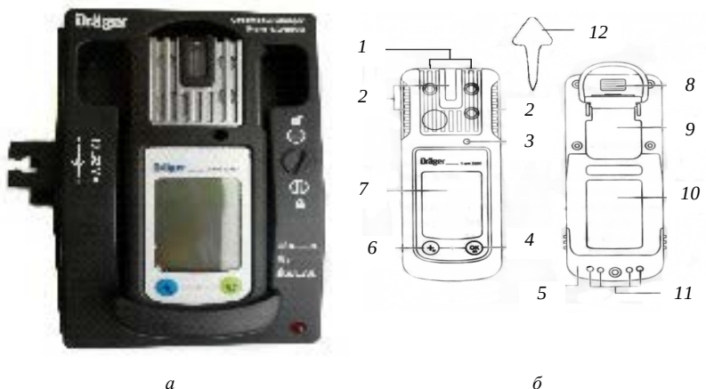
Рис. 23. Комплексный газоанализатор фирмы «Дрегер» для определения концентрации углекислого газа, аммиака и сероводорода: а – внешний вид; б – устройство газоанализатора: 1 – поступление газа; 2 – сигнальный светодиод; 3 – звуковое сигнальное устройство; 4 – кнопка ОК; 5 – блок питания; 6 – кнопка +; 7 – дисплей; 8 – ИК-интерфейс; 9 – зажим для крепления; 10 – паспортная табличка; 11 – зарядные контакты; 12 – инструмент для замены сенсора
