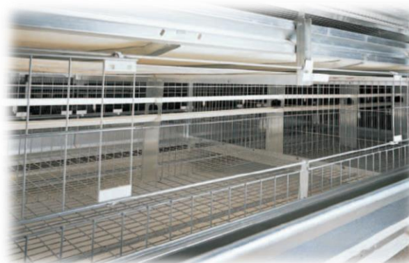
Рис. 9. Клеточная батарея UNIVENT Starter с ленточным удалением помета для выращивания ремонтного молодняка
