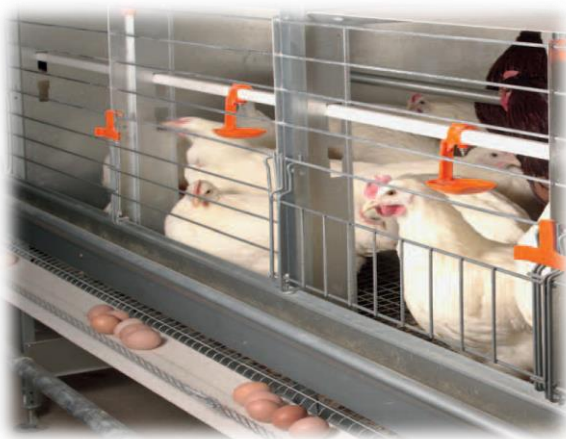
Рис. 7. Лента яйцесбора клеточной батареи
