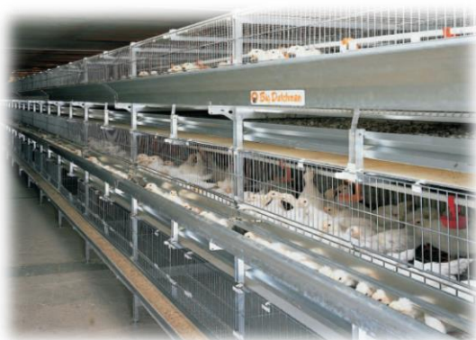
Рис. 9. Клеточная батарея UNIVENT Starter с ленточным удалением помета для выращивания ремонтного молодняка
