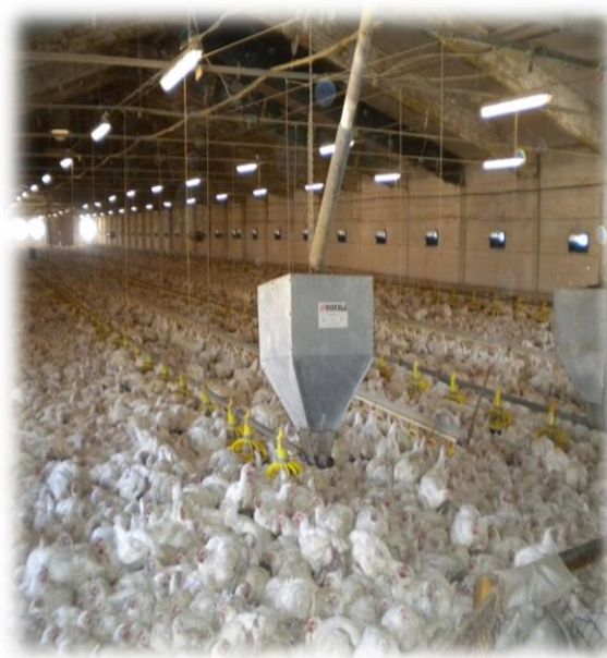
Рис. 3. Кормушки и бункер для раздачи кормов для птицы
