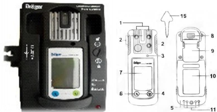
Рис. 24. Комплексный газоанализатор для определения углекислого газа, аммиака и сероводорода фирмы «Драгер» и его устройство: 1 – поступление газа; 2 – сигнальный светодиод; 3 – звуковое сигнальное устройство; 4 – кнопка ОК; 5 – блок питания; 6 – кнопка +; 7 – дисплей; 8 – ИК-интерфейс; 9 – зажим для крепления; 10 – паспортная табличка; 11 – зарядные контакты; 12 – индикация измеряемого газа; 13 – индикация измеренного значения; 14 – специальные символы; 15 – инструмент для замены сенсора.
