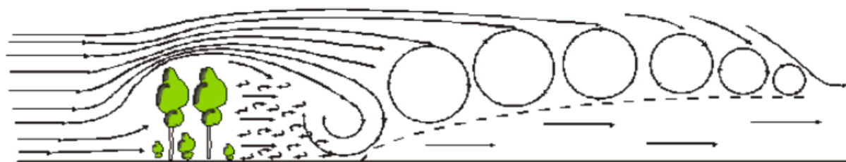
Рис. 7. Влияние полосы ажурной конструкции на движение ветра
