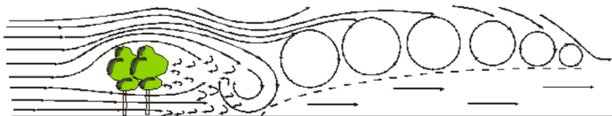
Рис. 9. Влияние полосы продуваемой конструкции на движение ветра
