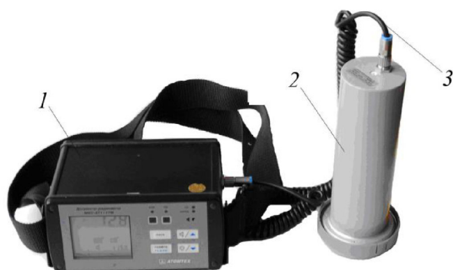
Рисунок 2.6. Дозиметр-радиометр МКС-АТ1117М: 1 – блок обработки информации (БОИ); 2 – блок детектирования БДПБ-01; 3 – соединительный кабель
