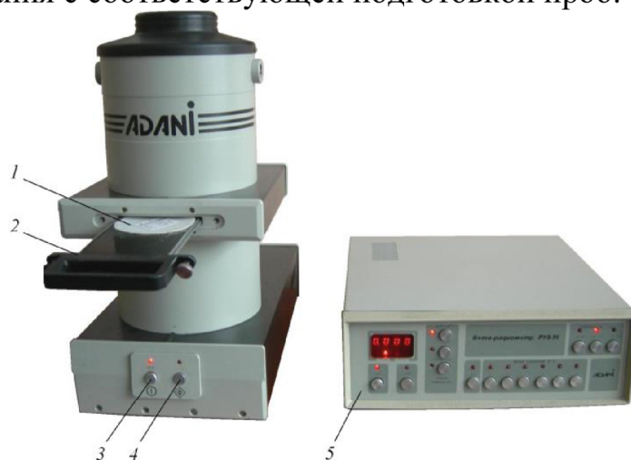
Рисунок 2.3. Общий вид бета-радиометра РУБ-91 «АДАНИ»:
