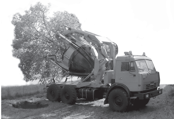
Рис. 10.5. Пересадка крупномерных деревьев машиной «Optimal 2200» на базе автомобиля КАМАЗ 43118
