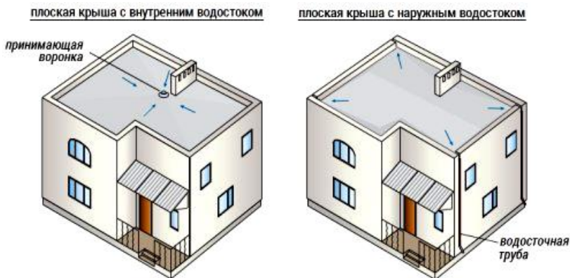
Рис. 83. Виды плоских крыш в зависимости от типа водосточной системы
