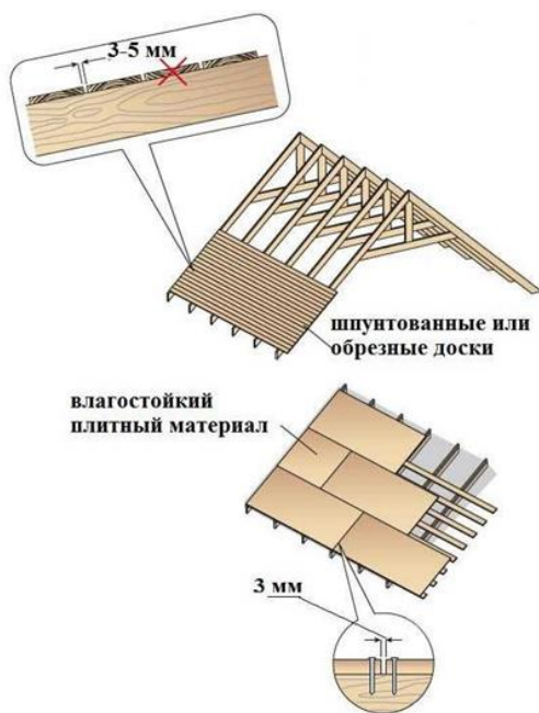
Рис. 117. Варианты устройства сплошной обрешетки под мягкую черепицу
