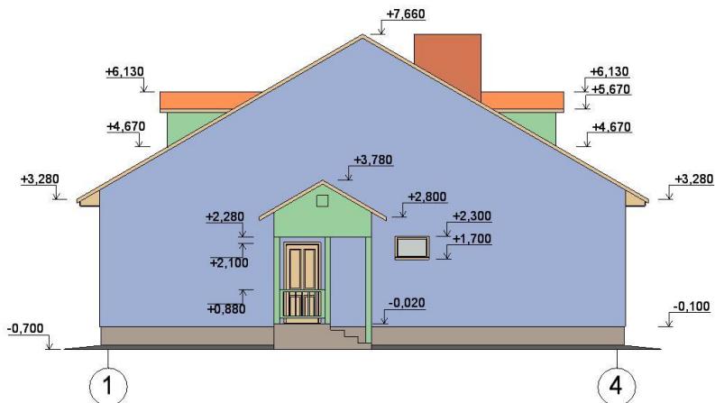
Рис. 180. Главный фасад 1–4 (двухскатная крыша)
