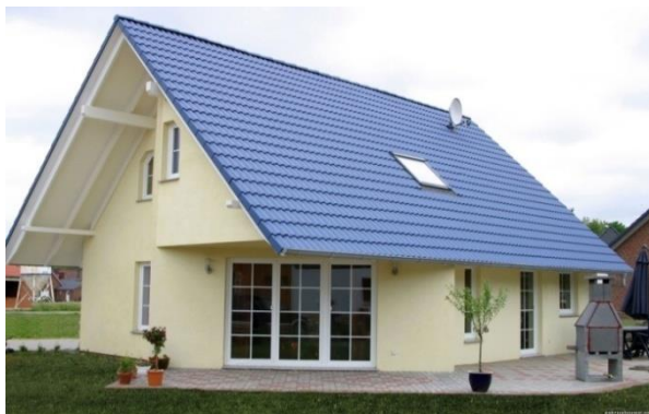
Рис. 115. Кровля из цементно-песчаной черепицы
