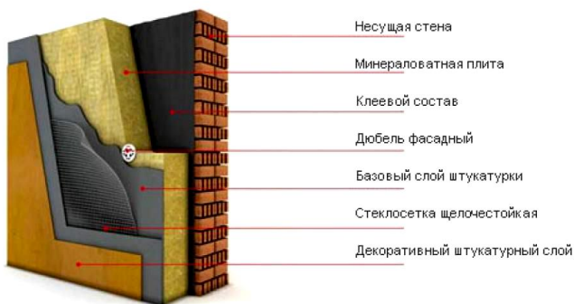
Рис. 15. Конструкция наружной стены с оштукатуренным фасадом
