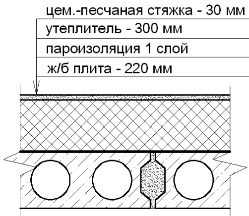
Рис. 7.9. Чердачное перекрытие в здании с холодным чердаком
