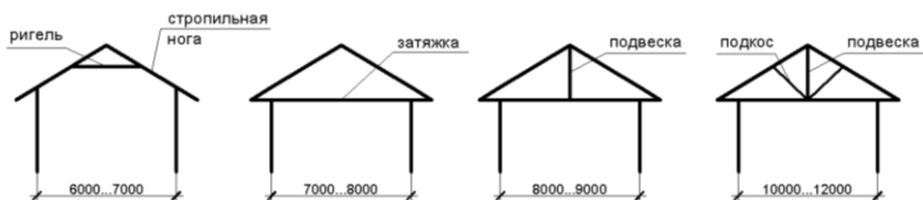
Рис. 8.8. Схемы висячих стропил
