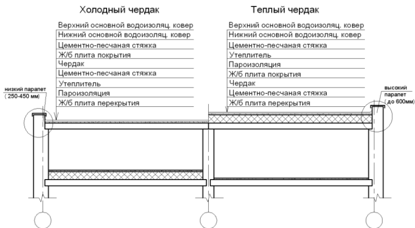
Рис. 9.3. Конструкция раздельной кровли
