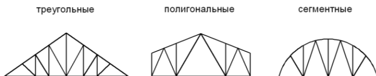
Рис. 7.10. Геометрические схемы ферм
