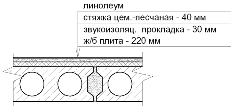
Рис. 7.7. Перекрытие с конструкцией пола из рулонных материалов
