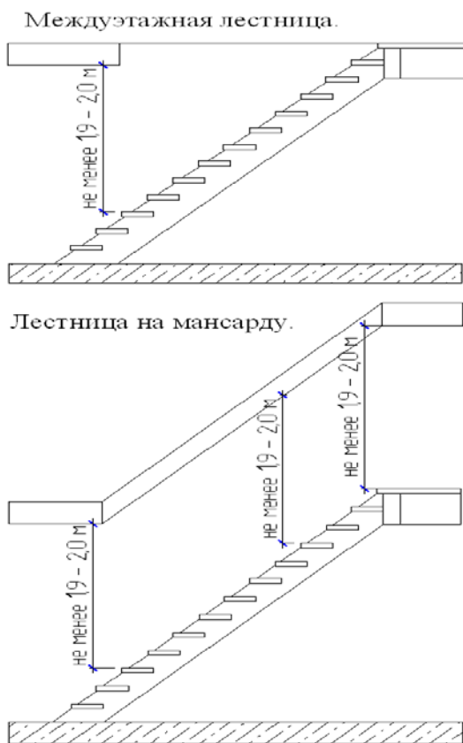
Рис. 33. Высота проема над лестничным маршем
