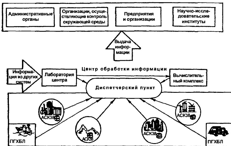
Рис. 15.7. Схема автоматизированной системы контроля качества поверхностных вод АНКОС-ВГ
