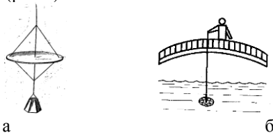
Рис. 2. Диск Секки(а) для измерения прозрачности воды и определение мутности (прозрачности) воды с помощью этого диска(б)
