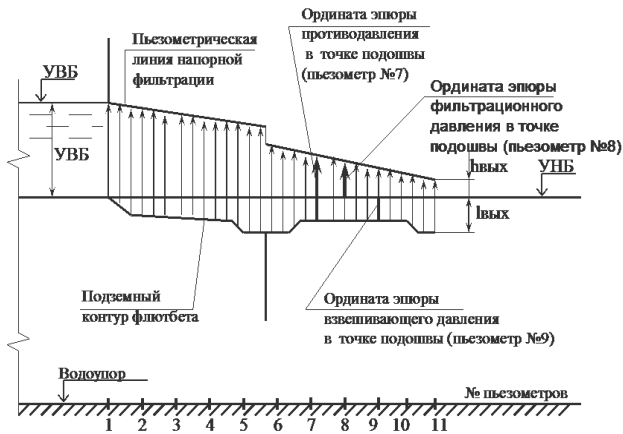
Рис. 2.3. Эпюра противодавления напорной фильтрации на подошву флютбета
