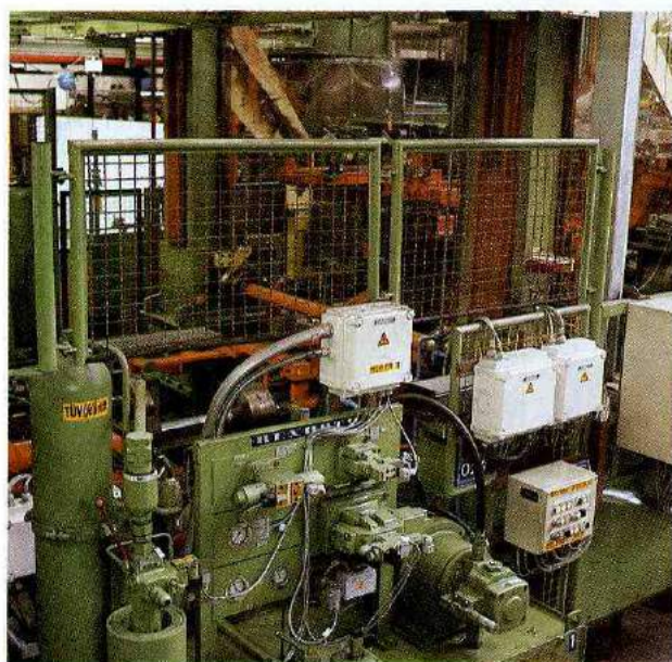
Требуемые для процесса ускорения 460 л/мин. поставляет аккумуляторный блок слева. Пластинчатый насос V4, расположенный справа, заполняет аккумулятор в неподвижных фазах. Справа размещается пропорциональный распределитель 4WRZ 25.
