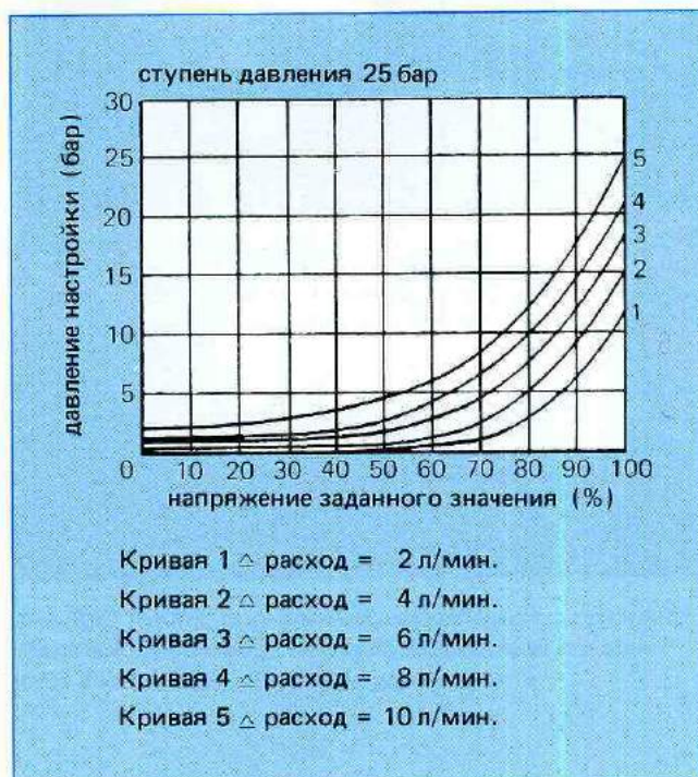
Рис. 40: Давление настройки в зависимости от напряжения заданного значения
