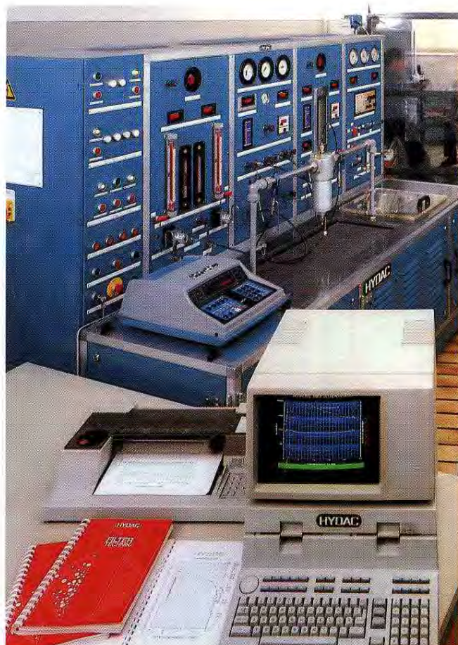
Рис. 7: Multipas - испытание согласно стандарту ISO 4572
