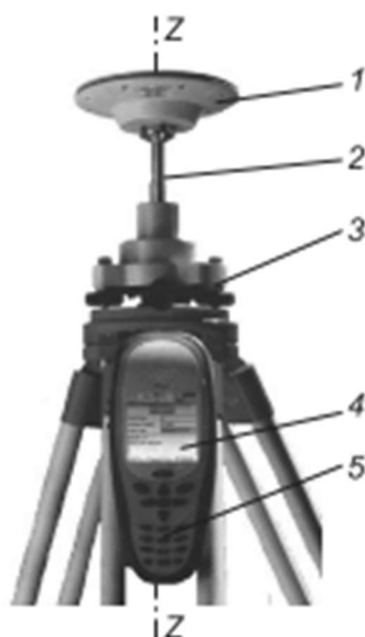
Рис.6.5. GPS-приемник LEICA SR20: 1 – корпус антенного модуля; 2 – выдвижная (телескопическая) штанга; 3 – подставка; 4, 5 – дисплей и клавиатура процессора; ZZ – вертикальная ось приемной части.
