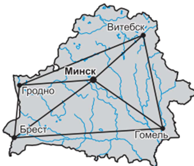
Рис. 6.6. Схема высокоточной геодезической сети (ВГС) Республики Беларусь
