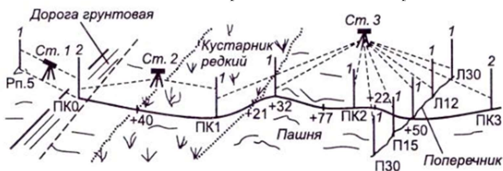
Рис.5.8. Схема начала трассы и нивелирования пикетных точек
