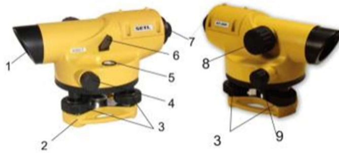
Рис. 4.5. Нивелир с компенсатором АТ20D
