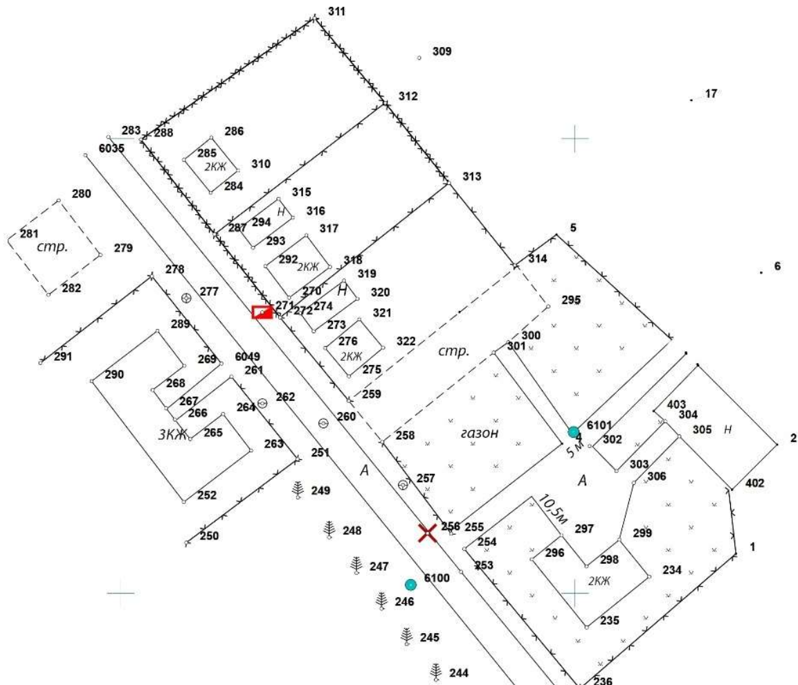
Рис 24. Абрис съемки электронным тахеометром
