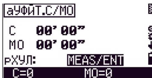
Рис. 11. Текущие значения место нуля и коллимационной ошибки.
