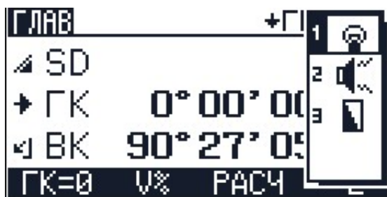
Рис. 5. Меню настройки подсветки экрана и звуковых сигналов
