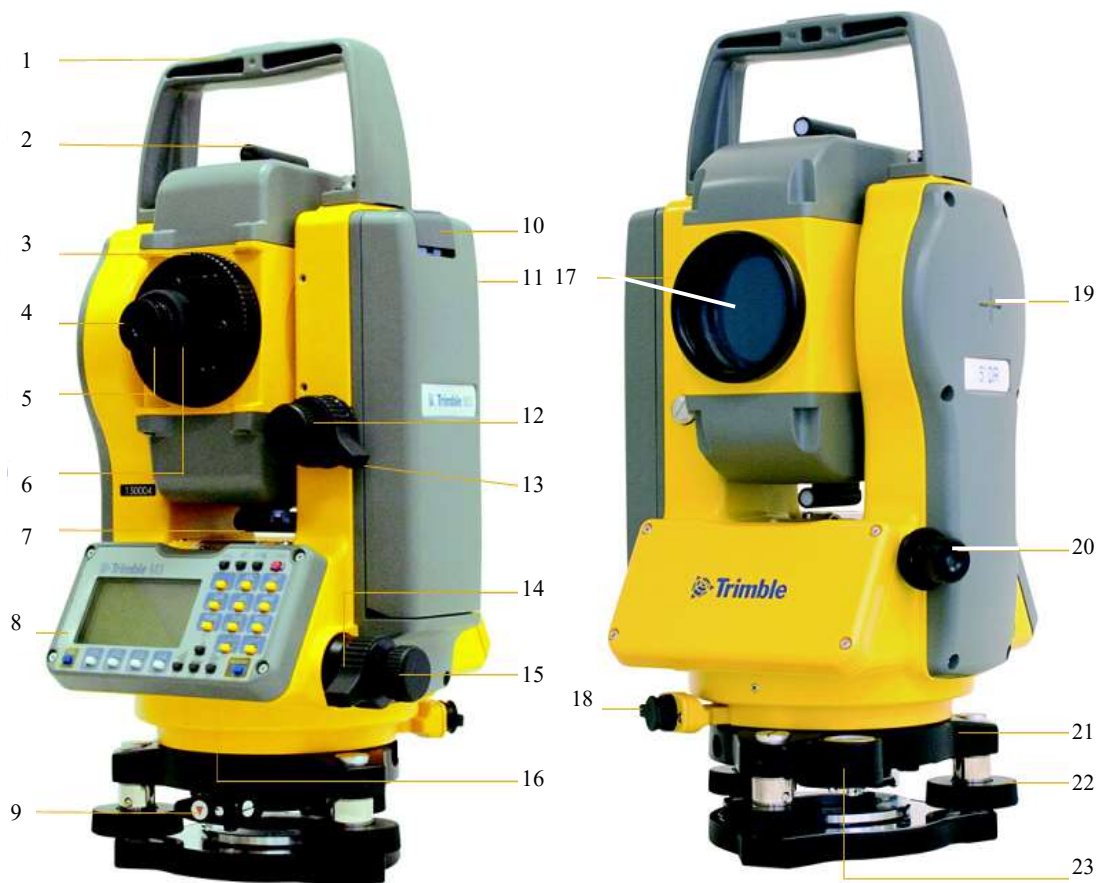
Рис. 1. Внешний вид прибора (а. со стороны панели управления, б. со стороны объектива.) 1. Ручка для переноски. 2. Визир наводки. 3. Кремальера зрительной трубы. 4. Окуляр зрительной трубы. 5. Кольцо фокусировки. 6. Крышка пластины визирных нитей. 7. Цилиндрический уровень. 8. Экран Стороны-1 и клавиатура. 9. Головка зажима трегера. 10. Кнопка фиксатора батареи. 11. Батарея ВС-65. 12. Винт точной наводки по вертикали. 13. Закрепительный винт. 14. Винт точной наводки по горизонтали. 15. Закрепительный винт. 16. Метка о безопасности работы с лазером, прикрепленная под клавиатурой. 17. Объектив. 18. Разъем вывода данных /Подключения внешнего питания. 19. Марка горизонтальной оси. 20. Оптический центр. 21. Трегер. 22. Винты трегера. 23. Круглый уровень.
