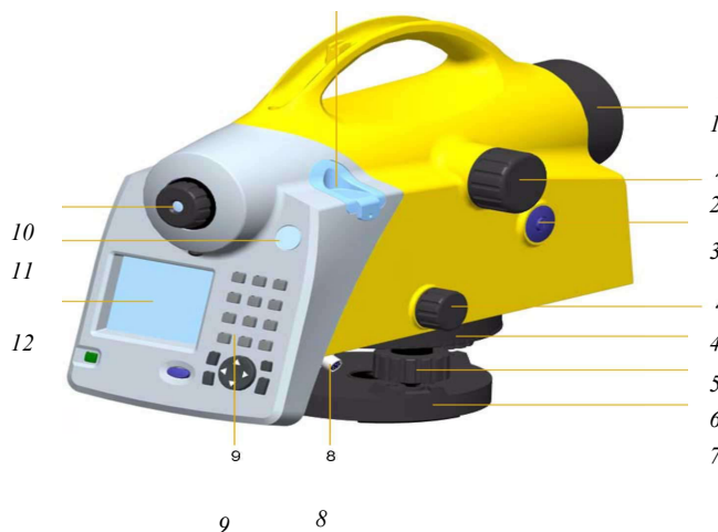
Рис. 1.8. Нивелир DINI, выпускаемый фирмой Trimble (США)
