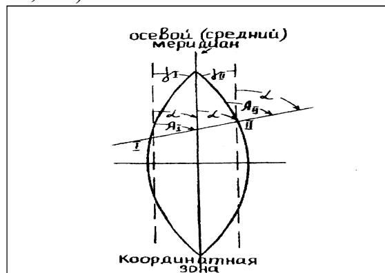
Рис. 5.1. Геометрическое изображение дирекционного угла, сближения меридианов, истинного азимута в координатной зоне
