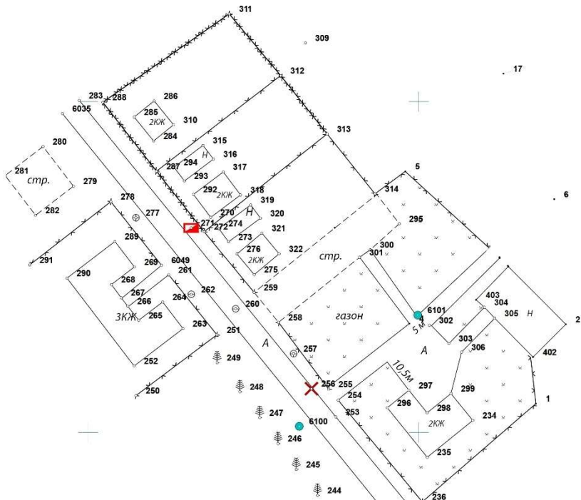
Рис 24. Абрис съемки электронным тахеометром
