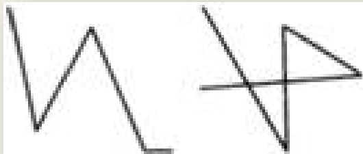
Пример линий типа «струна» (слева - допустимые, справа - нет)
