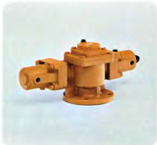
Качающий привод; крутящий момент до 2650 данм, давление до 200 бар более подробные сведения смотри RD 09 118
