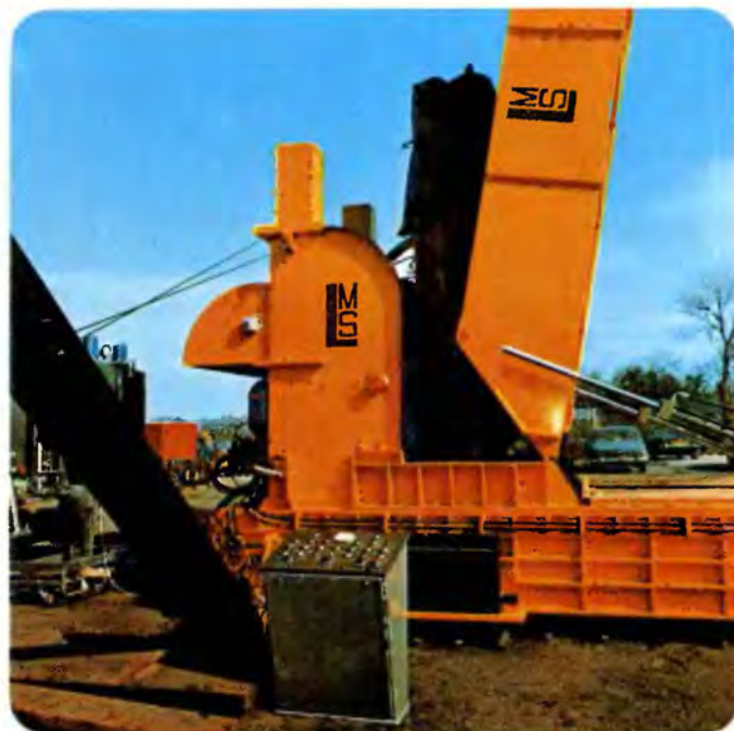
Пресс для резки и пакетирования старых автомобильных кузовов.
