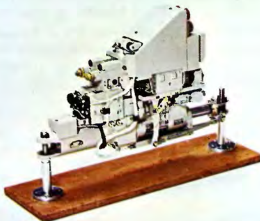
Исполнительное устройство руля направления для самолёта MRCS (Торнадо)
