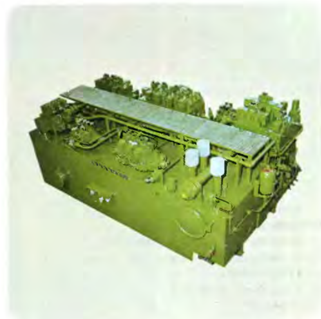
Комплектный привод алюминиевого профильного прес-са мощностью 2500 т.
