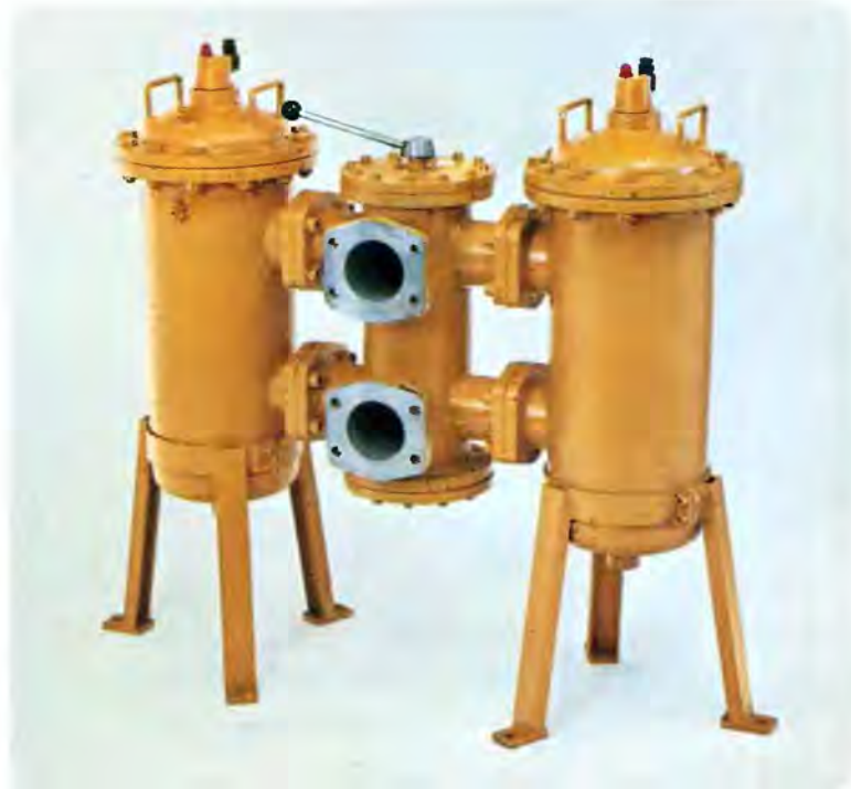
Справа изображен фильтр линии слива, выполненный в виде двойного фильтра с оптическим электроиндикатором загрязнения.
