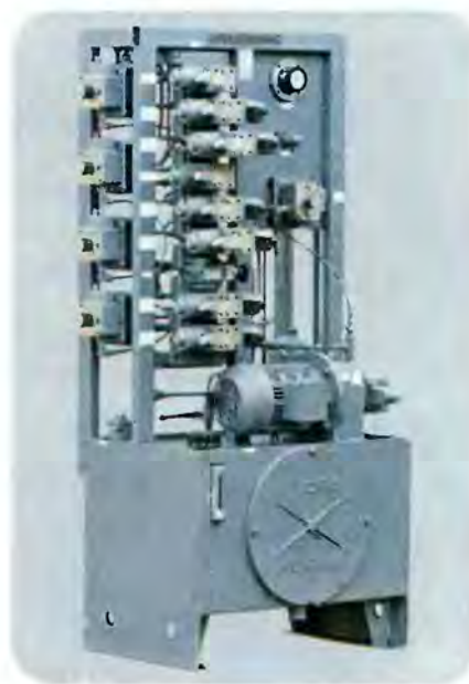
Агрегат насос - бак с передней панелью блочной конструкции.
