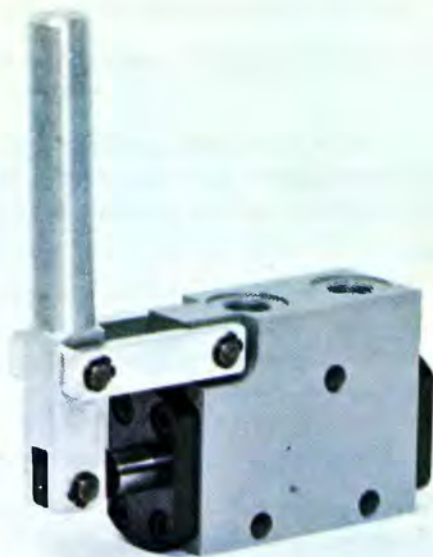
Ручной насос двойного действия, давление до 315 бар, производительность = 25 см 3 /двойной ход, вес = 2,3 кг
