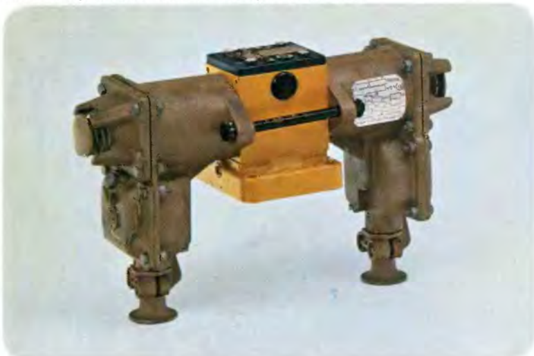
Ходовой распределитель с электрическим управлением, взрывозащищенный (защитное исполнение: (Ex)s G4), защищенный к действию морской воды более подробные сведения смотри RD 09 168
