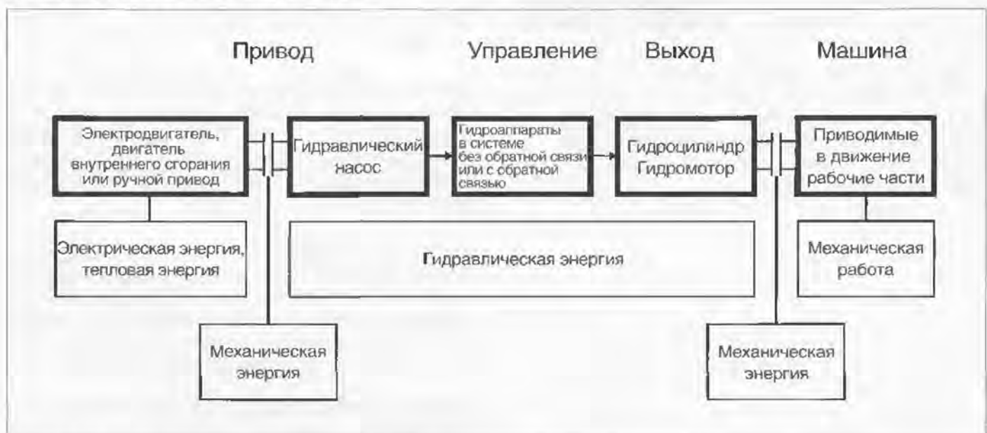
Рис. 1.13. Передача энергии в гидроприводе
