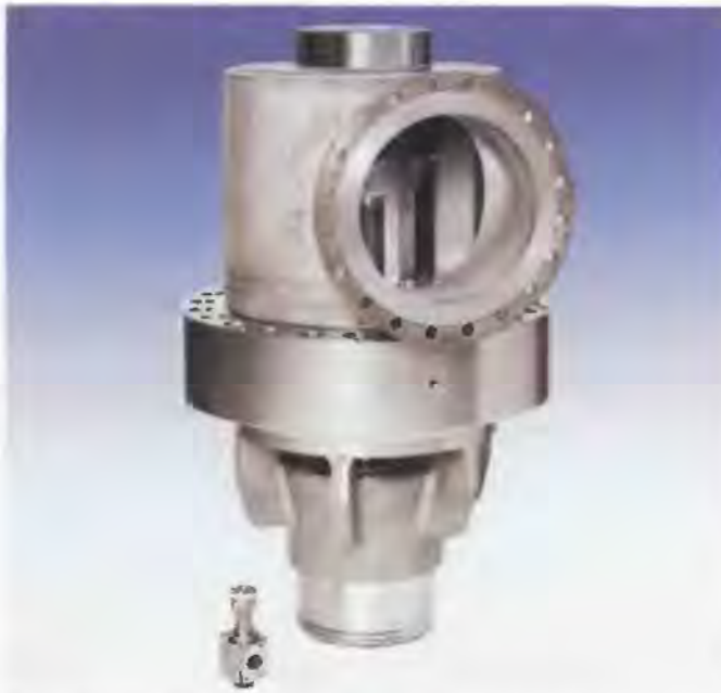
Рис. 10.20. Клапан наполнения с диаметром условного прохода D_y = 500 мм (NG 500) ( p_{\max} = 350 бар; Q_{\max} = 50000 л/мин) в сравнении с клапаном, имеющим D_y = 40 мм (NG 40)
