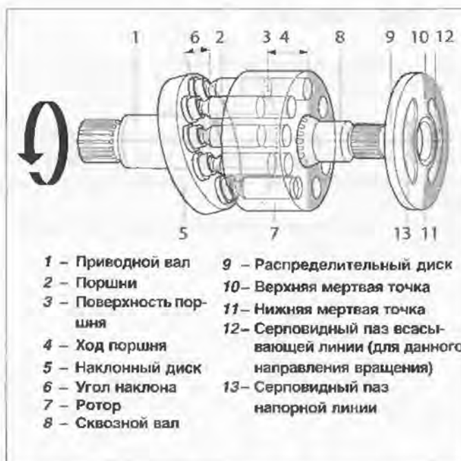
Рис. 6.18. Принцип наклонного диска — элементы конструкции
