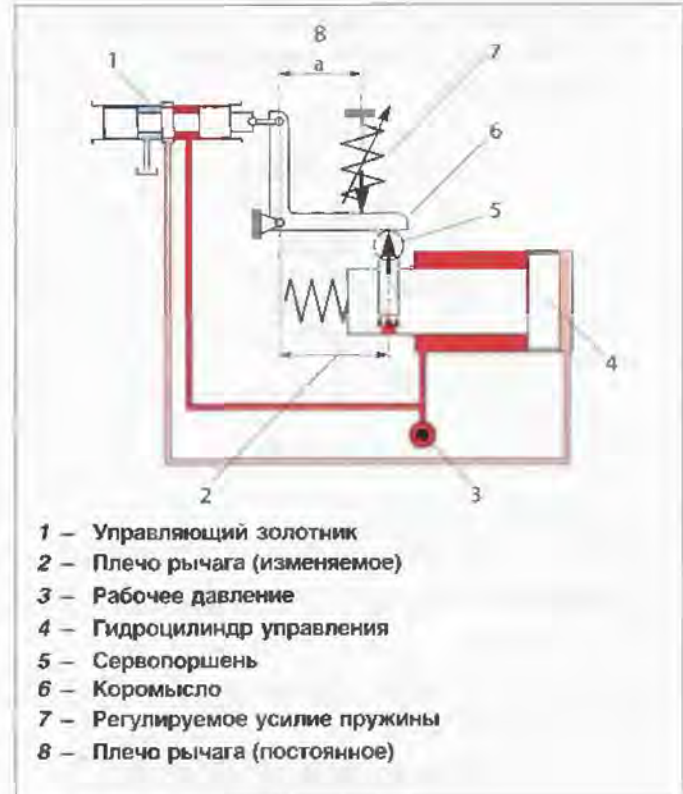
Рис. 6.37. Регулятор мощности
