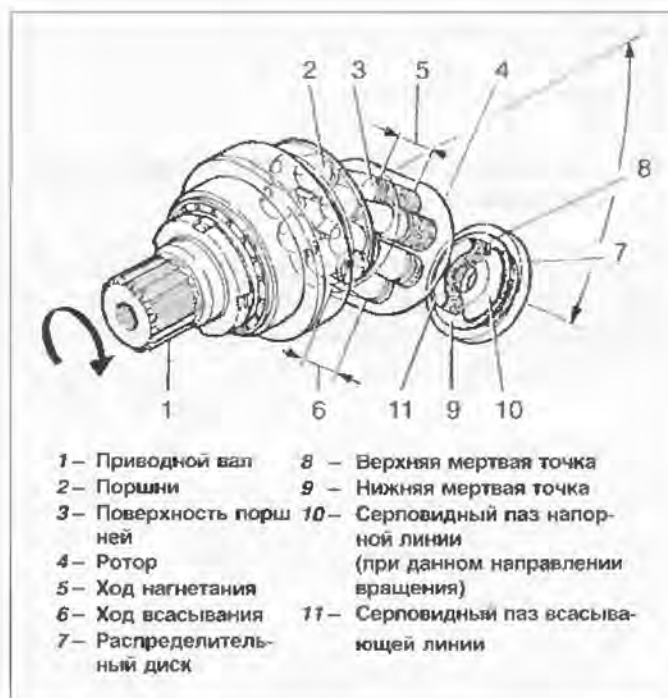
Рис. 6.8. Принцип наклонного блока – конструктивные элементы
