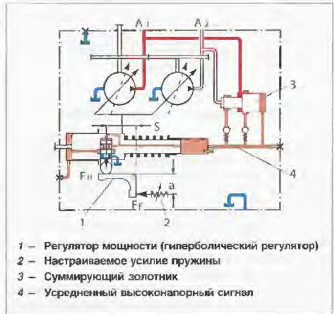
Рис. 6.41. Суммирующий регулятор мощности
