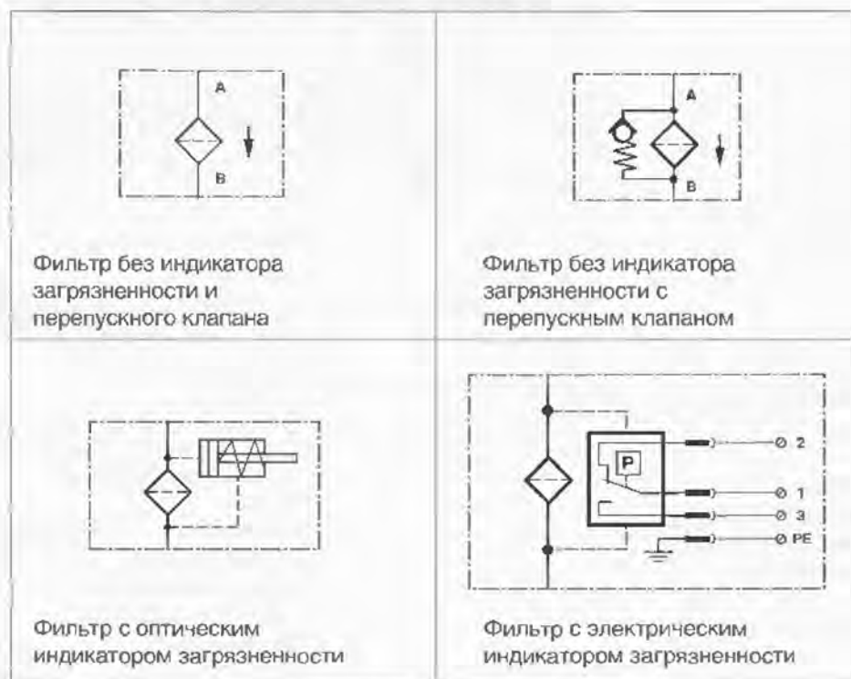
Рис. 14.16. Условные обозначения напорных фильтров
