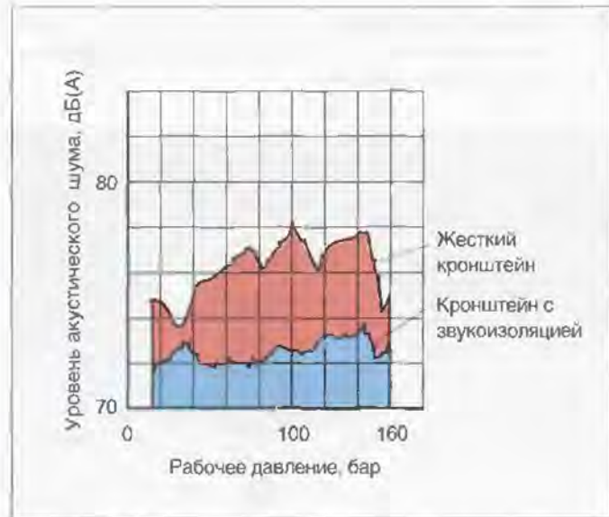
Рис. 15.4. Акустический шум в зависимости от рабочего давления и типа кронштейна насоса
