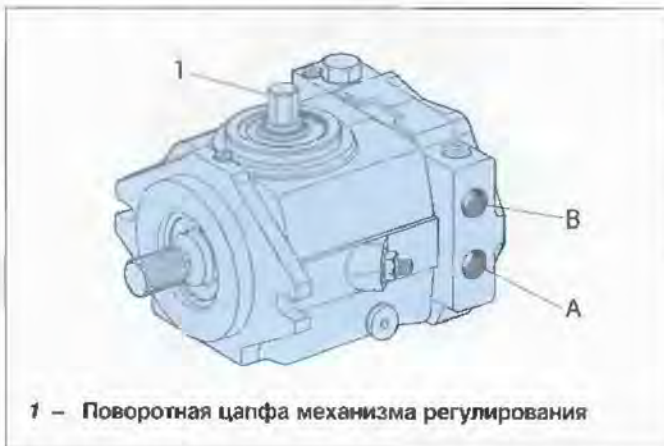
Рис. 6.44. Регулируемый насос с наклонным диском и механическим регулирующим устройством
