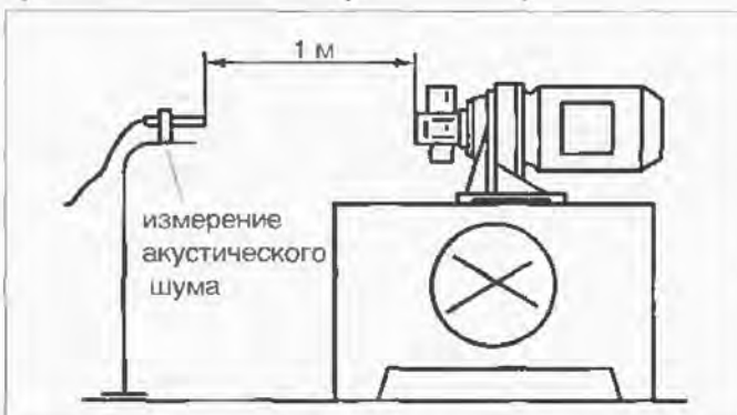
Рис. 15.3. Кронштейн насоса с звукопоглощающим устройством
