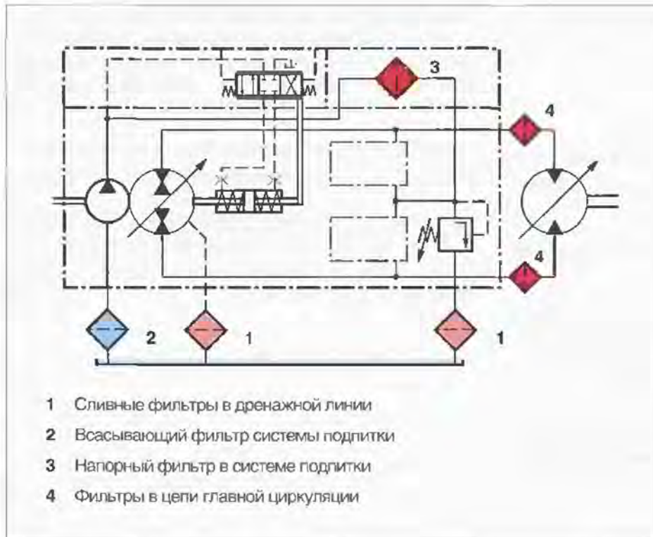
Рис. 14.29. Размещение фильтров в системе замкнутой циркуляции
